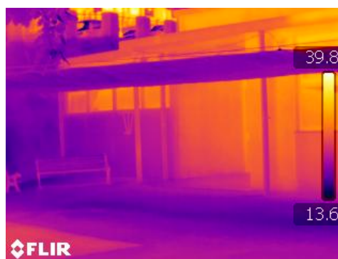
Figura 4.3 – Rilievo termografico della parete interno cortile con esposizione sud-ovest
